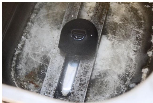
Bild 5: Das fertige Werkstück wird in ein 80°C warmes Wasser gelegt, um so das WEIGUSS auszuschmelzen und das fertige Bauteil entnehmen zu können
