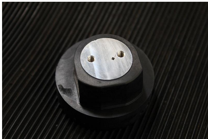
Bild 3: sobald das WEIGUSS erstarrt ist, wird es mit Gewinden versehen, die später als Befestigungsbohrung dienen
