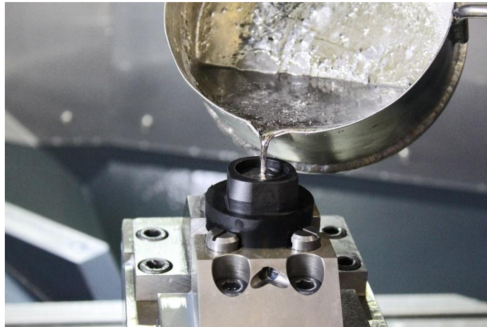
Bild 2: Witte WEIGUSS wird erhitzt (ca. 70°C), dadurch verflüssigt sich das Metall und lässt sich wie hier dargestellt, einfach wie Wasser gießen. Das Werkstück wird damit eingegossen
